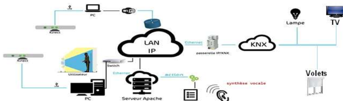
Figure 57. Interconnexion réseaux IP/KNX
