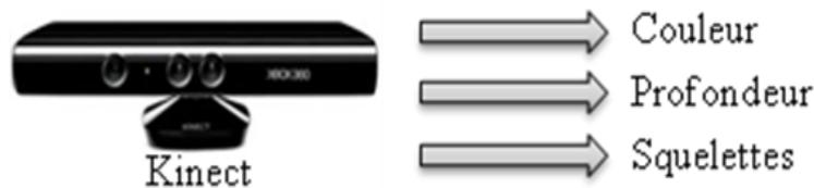
Figure 2 : Eléments de sortie de la Kinect
