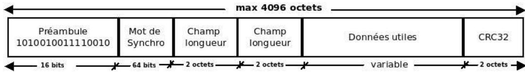
Figure 8. Format de base d'une trame USRP/GNU Radio avant les modifications
