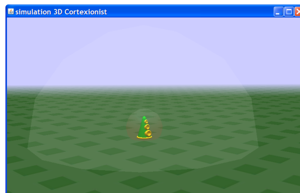
FIG. 4.4 – Les capteurs ont un rayon de perception limité. En blanc, la demi-sphère qui délimite la vision de l'agent. En rouge, la sphère associée au capteur de proximité. Toute intrusion à l'intérieur de cette sphère active le neurone proximité .
