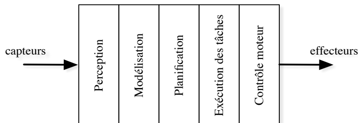
FIG. 2.5 – L'architecture comportementale traditionnelle de l'IA, également appelée SPA ( sense, plan, act ) dans le domaine de la robotique.
