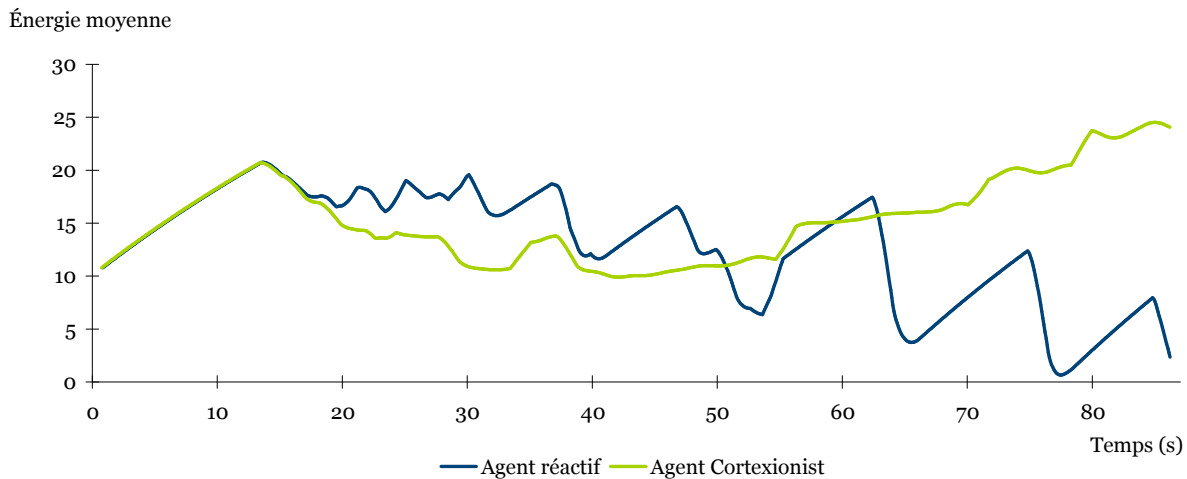
FIG. 4.13 – Courbes comparant l'énergie des agents réactif et Cortexionist dans la première expérience. L'agent Cortexionist est capable d'économiser son énergie vitale.
