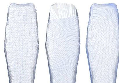
Figure 12: SCREWDRIVER remaillé avec MAPS sans supervision de l'utilisateur. A gauche : l'original. Au milieu : MAPS non supervisé. A droite : MAPS avec une technique automatique de préservation d'arêtes lors de la simplification [KPA09].
