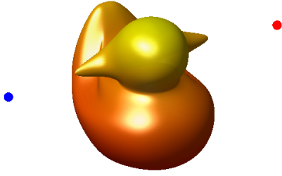
Figure 10: La translation d'un point de contrôle (en rouge) synchronise la translation du point de contrôle correspondant (en bleu) par rapport à la symétrie détectée.
